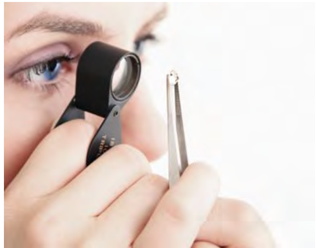
鑽石分級實習班學生使用 10 倍珠寶放大鏡評估鑽石的淨度 - © GIA
